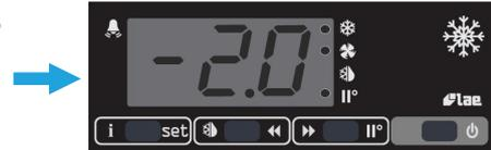
Die Testfunktion ist eine definierte Sequenz von Ereignissen, die im Anschluss an ein vorgeschriebenes Muster (je nach den Parameterwerten) durchgeführt werden und die alle elektrischen Elemente des Systems verwenden und damit ein kurzes Bedienungsmuster simulieren. Der Techniker sollte damit einfache Funktionsprüfungen aller Systemkomponenten einschließlich der Kühlung durchführen können.
