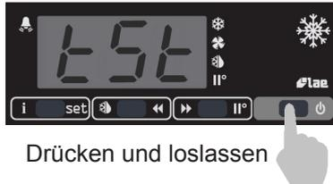
Hinweis: Wird das Element nicht gedrückt, so wird der Test fortgesetzt; nach Abschluss zeigt der Controller „End“ an. Warten Sie eine Minute und setzen Sie dann den normalen Betrieb fort.
