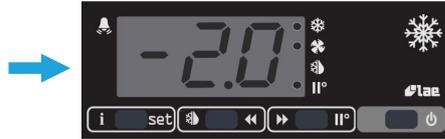
Hinweis: Wenn Sie dieses Element drücken und fünf Sekunden lang gedrückt halten, wird eine „Prüfsequenz“ gestartet (siehe Anleitungen unten).
