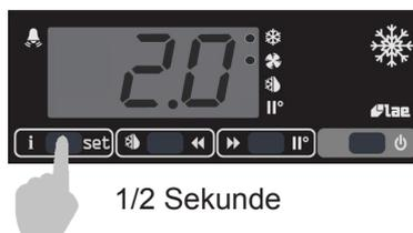
Halten Sie die Taste **i** gedrückt und drücken Sie die Tasten **◀** und/oder **▶**, um den gewünschten Wert einzustellen (Einstellung zwischen dem minimalen SPL-Wert und dem maximalen SPH-Wert)
