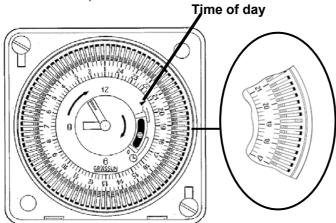
CARE SHOULD BE TAKEN WHEN SELECTING THE PROVE START TIME. PROVE START TIME SHOULD BE, PRODUCT REQUIRED TIME LESS PROVE DURATION.
